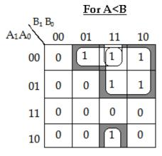
$A \le B = A_1 A_0 B_0 + A_0 B_1 B_0 + A_1 B_1$ Logic Diagram:
